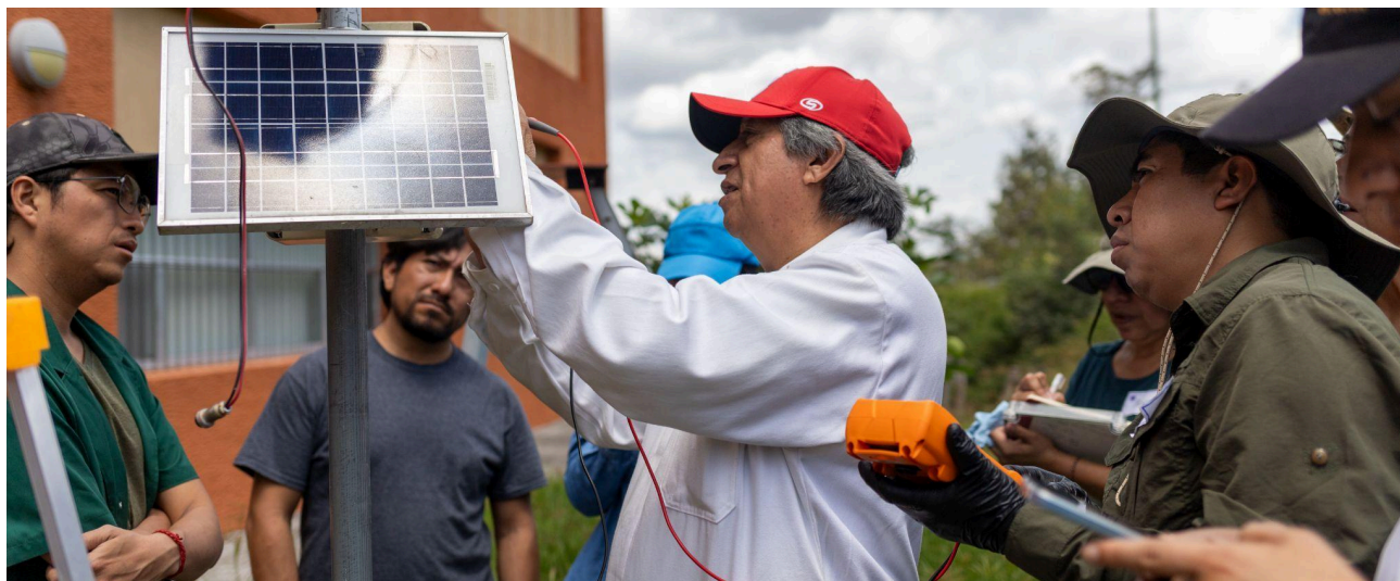
Fotografía 3. Práctica de campo: revisión de estación hidrometeorológica.
